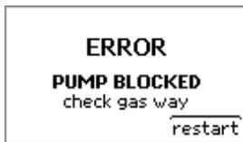
Wenn ein Fehler erkannt wird, wird die Fehlermeldung mit einer kurzen Beschreibung angezeigt. In diesem Fall reagiert das Gerät nicht auf Gas und funktioniert nicht normal.
